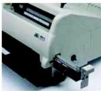
Mudança do pente de furação rápida e fácil
